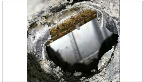
シーソの内側の腐食状況
