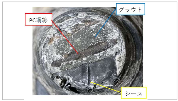
シーソの内側の腐食状況
