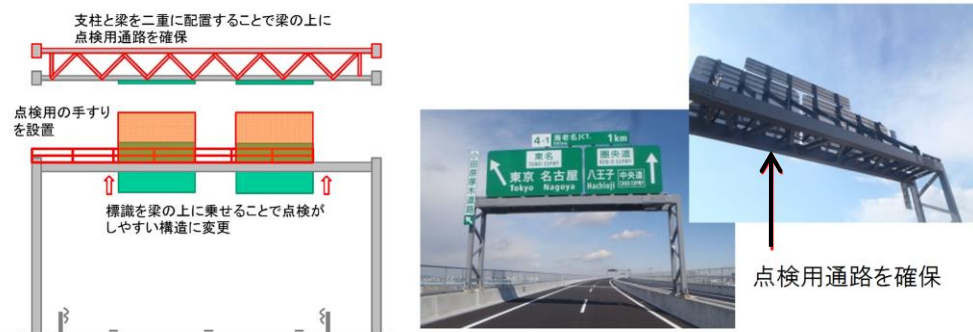
《維持管理しやすい道路の設計・施工の取組提案事例》 大型標識の点検用通路の確保
