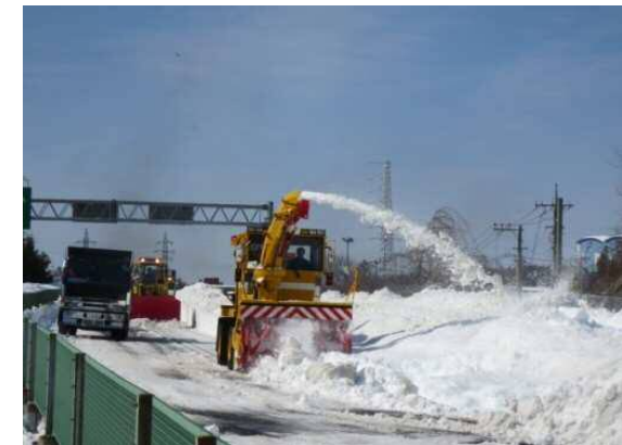
ロータリー除雪車による排雪作業状況
