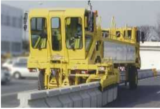
【移動式防護柵切替車両による防護柵移動状況】
