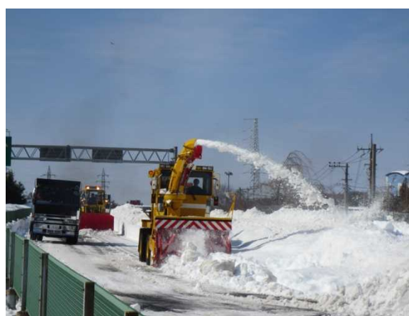
排雪作業状況(中央道大月地区)
