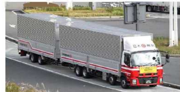
【図12 ダブル連結トラックによる輸送効率化】
