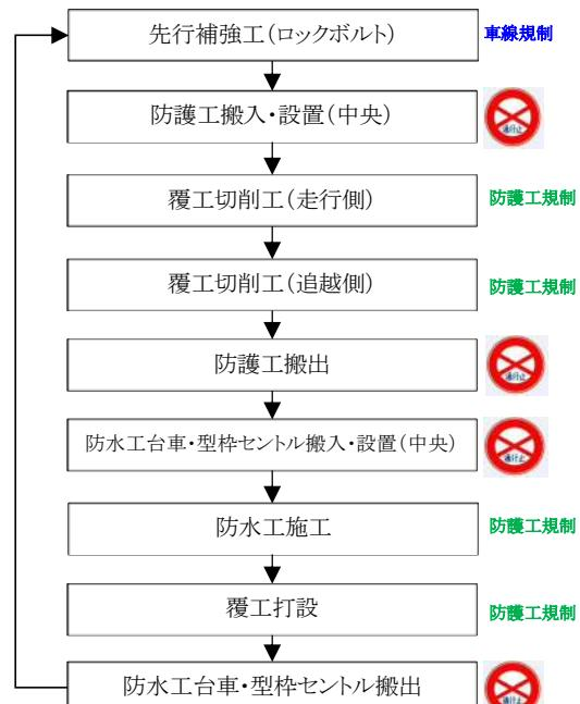
図 4.1 覆工再生工法 施工フロー(案)
