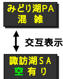
仮設LED板による休憩施設の混雑情報の提供
