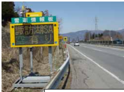
仮設LED板による休憩施設の混雑情報の提供
