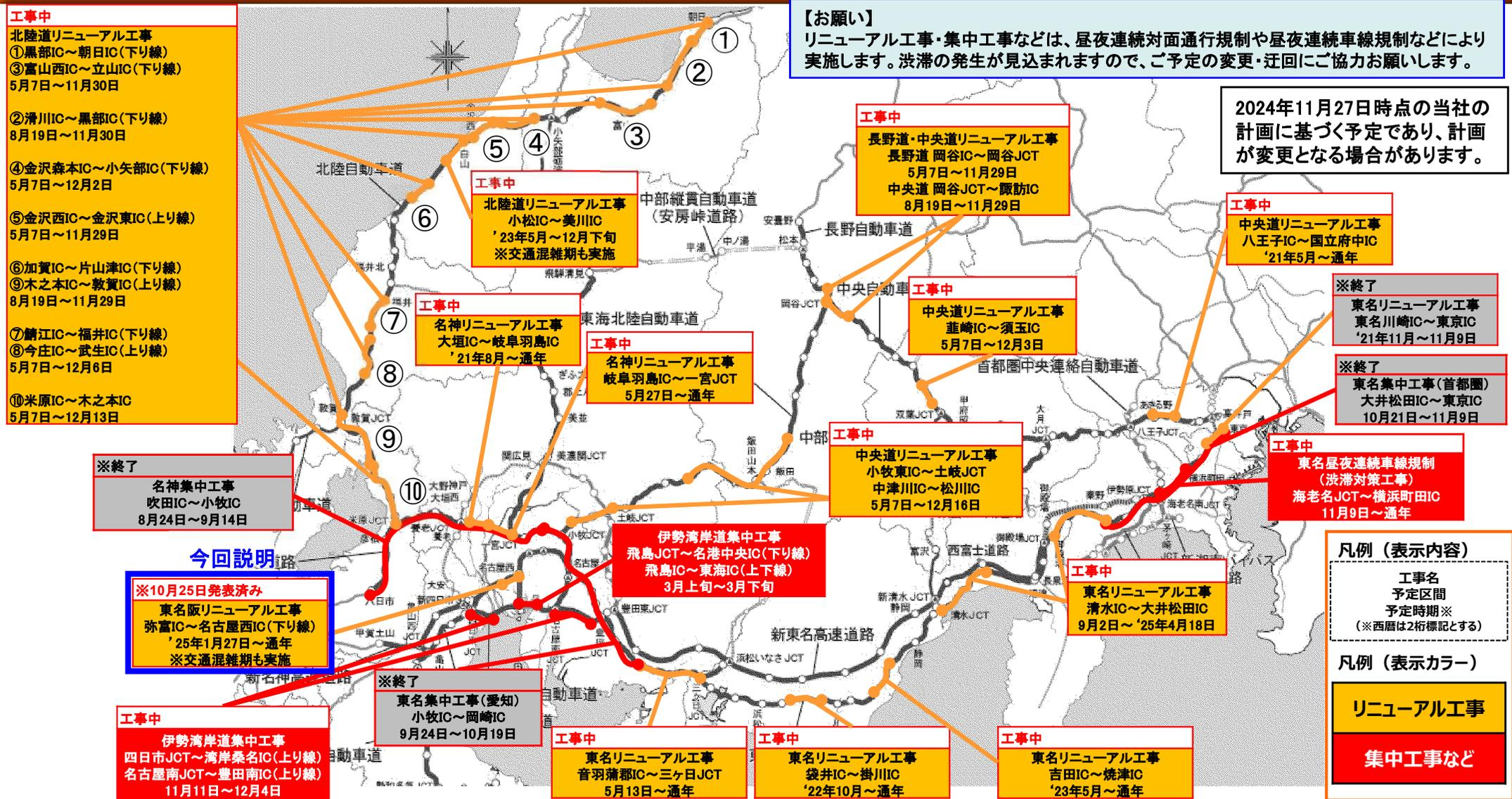
リニューアル工事：高速道路リニューアルプロジェクトの一環として実施する「床版取替」など、長期間（半月程度以上）にわたり休日を含み対面通行規制・車線規制・通行止めなどのもと実施する工事
