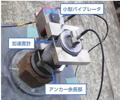
写真-4 VIBRES® システムの取り付け状況
