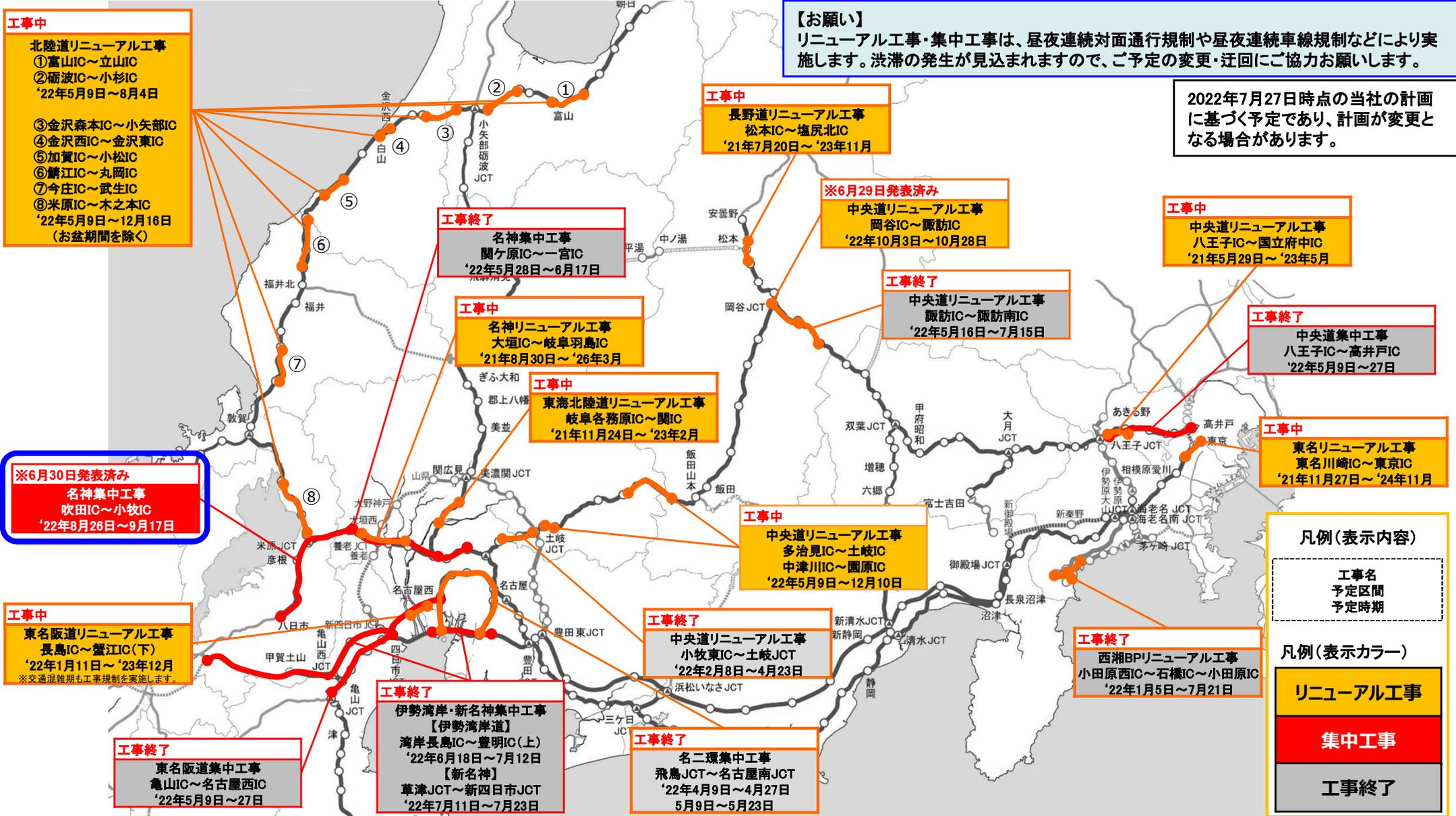
リニューアル工事：高速道路リニューアルプロジェクトの一環として実施する「床版取替」など、長期間（半月程度以上）にわたり休日を含み対面通行規制・車線規制・通行止めなどのもと実施する工事
