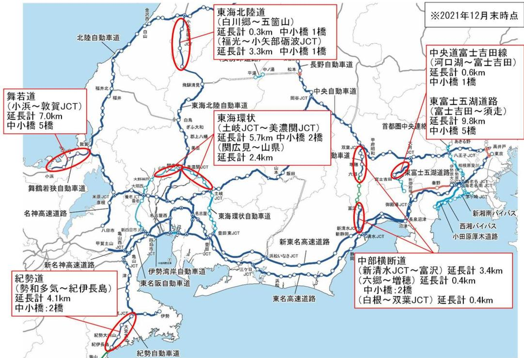
図5 ワイヤロープの設置箇所
