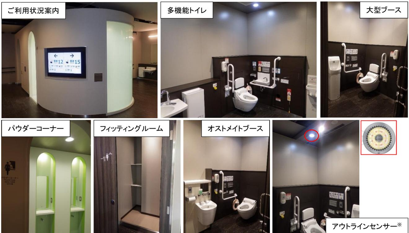
※天井に設置したセンサーで忘れ物や急病人を発見し音声と光でお知らせするシステム
