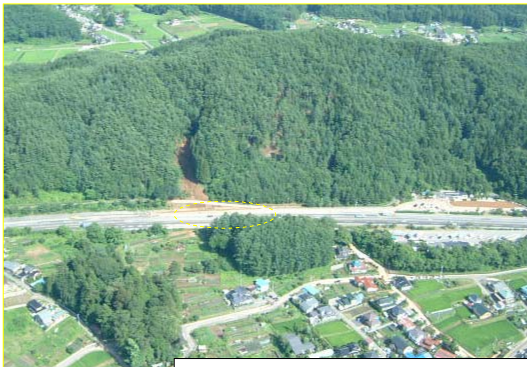
高速道路上に流木などが堆積し下流域の田畑へ流出を防いだ
