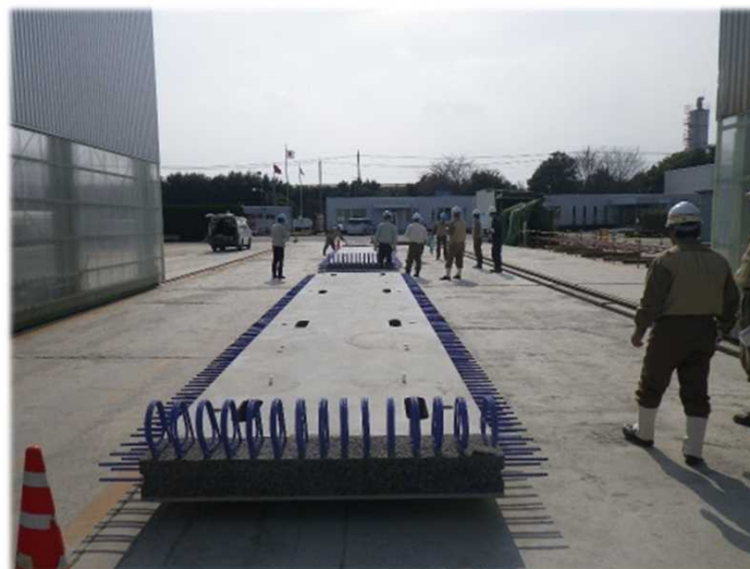
■ 用宗高架橋で実際に使用するプレキャストPC床版・製品検査状況
