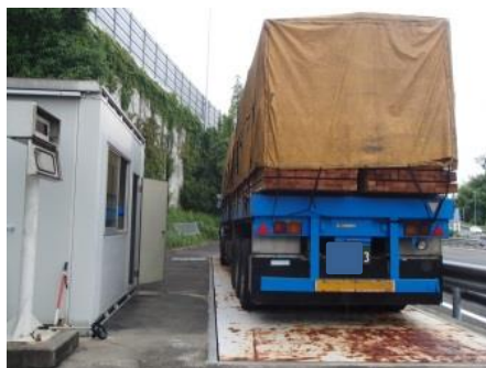
車重計により重量超過判明
