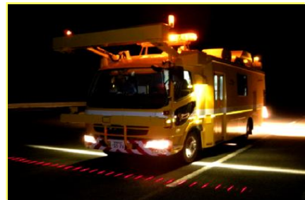
道路形状調査状況
