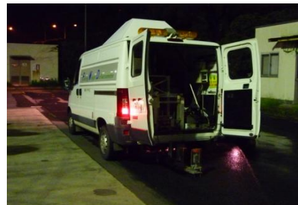
FWD 調査状況
