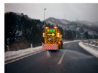
■ 凍結防止剤散布作業
