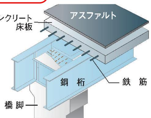
アスファルトのひび割れから雨水などともに凍結防止剤がしみ込み、その下にあるコンクリート内にある鉄筋が錆びるなどコンクリート床版が劣化しています。
