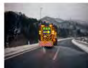
■ 凍結防止剤散布作業
