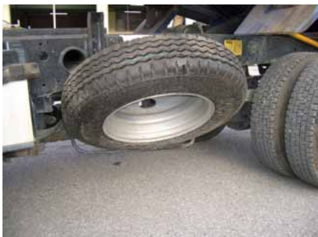
写真1．スペアタイヤの取付状況
