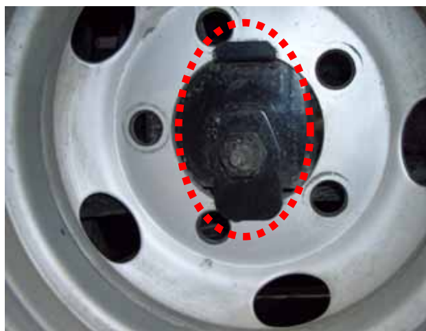
写真2．取付ボルト・金具の設置状況
