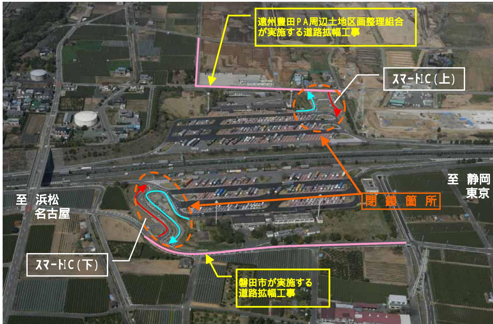
現在営業中のスマートICについて、全車種利用可能とするためのランプ線形改良工事などと、磐田市及び遠州豊田PA周辺土地区画整理組合が行なうスマートIC接続道路の拡幅等改良工事を実施するため、スマートICを一時全面閉鎖いたします。
