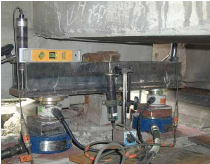
原位置引抜き試験状況
