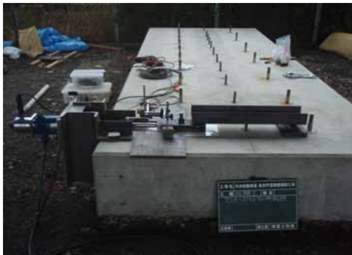
供試体せん断試験状況
