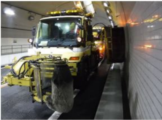
<トンネル壁面清掃>
