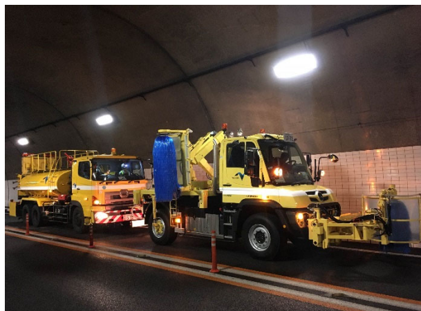
トンネル側壁清掃(イメージ)
