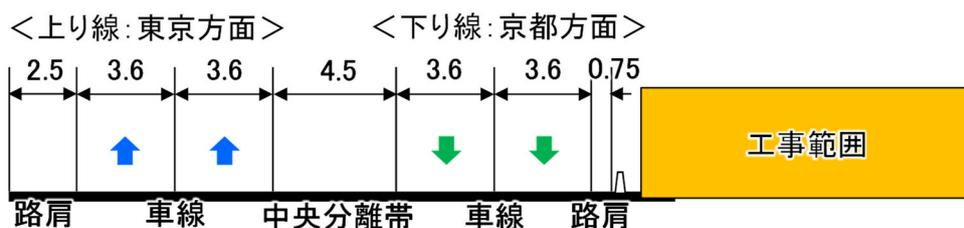
車線シフト後:上下線の幅員構成が変更となりますので、安全に通行をお願いします。下り線(京都方面)では、車線幅員が3.25mとなるため、車幅3.0m超過の特殊車両はご通行いただけません。
