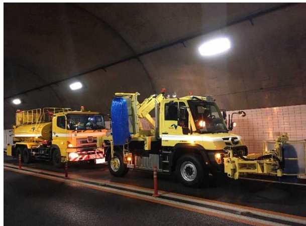
《トンネル側壁清掃》
