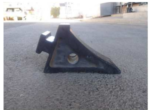
飛散した車止め(高さ150mm×幅100mm)
