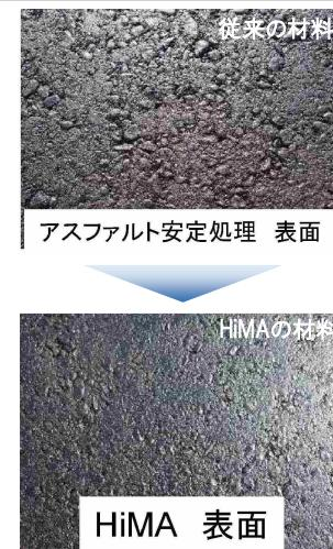
従来の材料と比較して、骨材の最大粒径が小さく、空隙率が小さい
