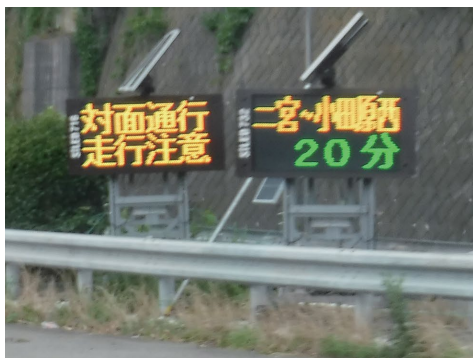
【迂回ルートへの分岐部手前の専用の道路交通情報板の所要時間表示イメージ（過年度設置状況）】
