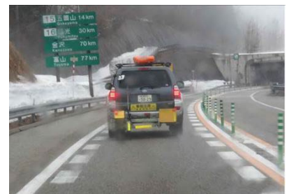
参考写真 1 連続路面すべり抵抗値測定車(寒地土木研究所所有)による測定状況
