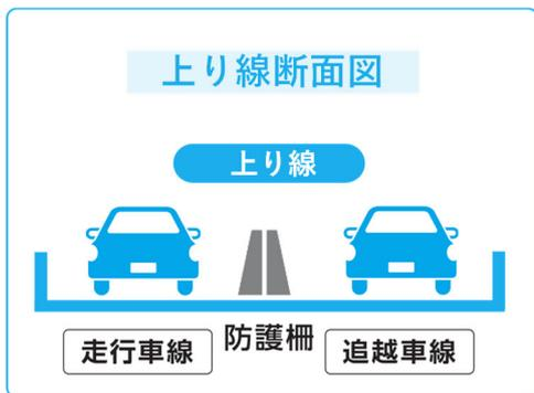
走行車線と追越車線の間に防護柵を設置しております。
