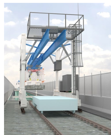
床版架設機・撤去機（イメージ）
