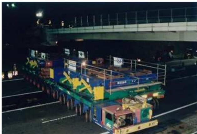
(多軸台車を跨道橋の桁下へセットする事例)
