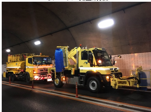
《トンネル側壁清掃》
