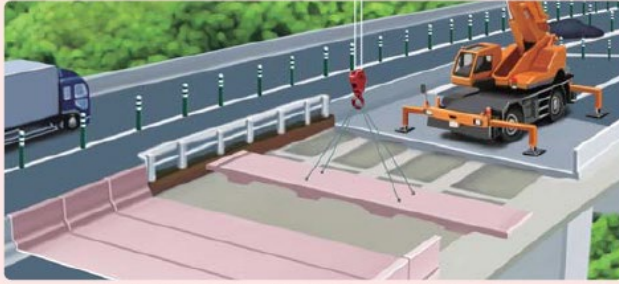
老朽化した床版を撤去し、新しい床版パネルを クレーンで1枚ずつ設置していきます。
