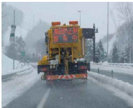
【写真 10】凍結防止剤散布状況
