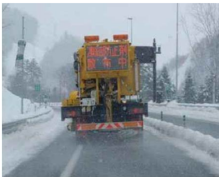
【写真6】凍結防止剤散布状況
