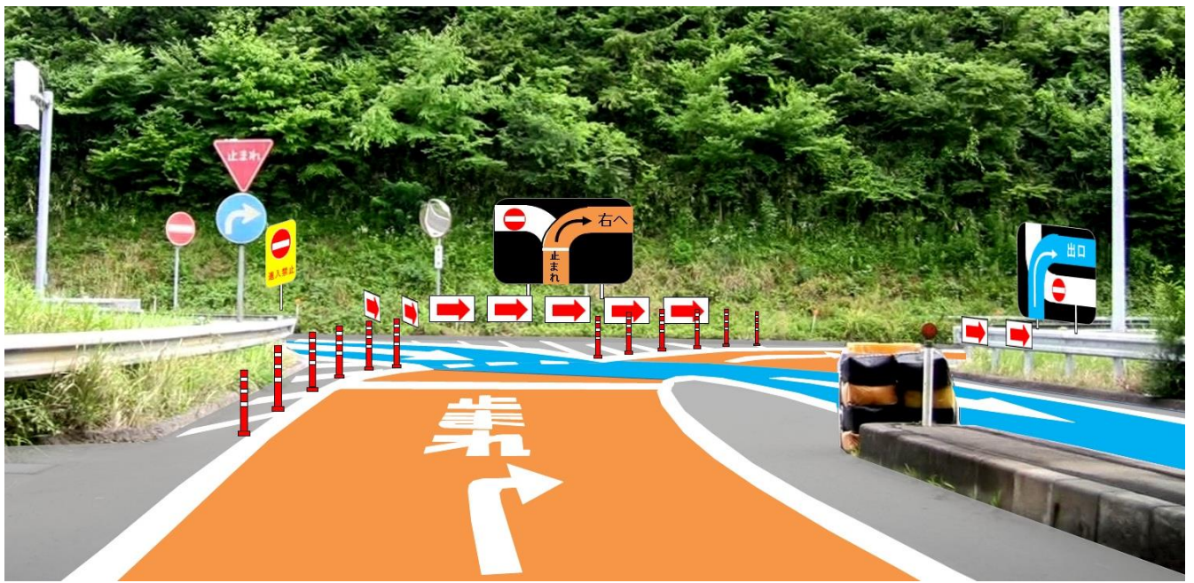
《対策の基本パターンの運転者からの見え方イメージ(平面 Y 型 IC 交差点部)》
