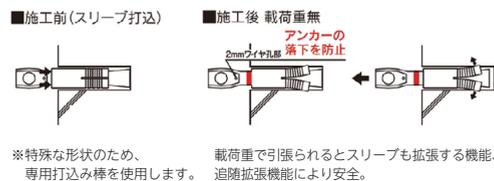
※特殊な形状のため、専用打込み棒を使用します。 載荷重で引張られるとスリーブも拡張する機能、追随拡張機能により安全。
