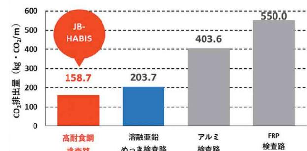
横桁間隔 6m タイプの CO<sub>2</sub> 排出量比較 (1m 当り)
