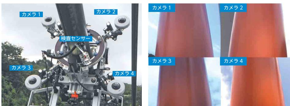
点検ロボットは4つのビデオカメラを装備し、保護管全周を動画撮影します。動画はリアルタイムで地上に設置したPCでモニタリングを行うと同時に点検データを蓄積します。また、撮影方向の無線操作カメラを導入し、遠隔でカメラの焦点および撮影位置調整、ズームアップ等の操作ができます。また、1カメラにつき2つの照明を付加し、走査時の焦点ズレ防止、逆光防止の対応を図っています。
