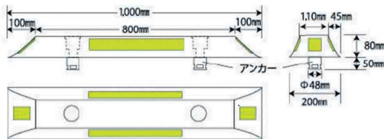
※設置時の推奨値 アンカー長 L=50mm / 削孔径φ 70mm
