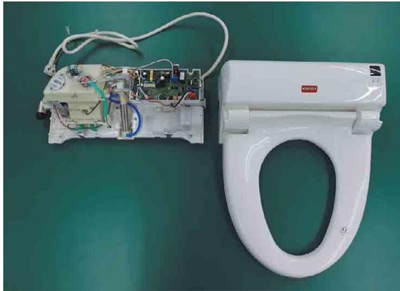
座面やカバーが破損した場合は、本体機構をそのまま残しカバー部分だけを取り外して交換できます。
