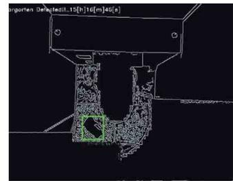
ブース内の忘れ物をアウトラインセンサーの撮像素子によって検知
