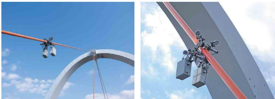
本装置は、斜張橋の斜材の外観変状および内部鋼材の変状を非破壊で点検できる自走式の点検ロボットです。斜材の保護管表面の破損状況を、カメラ撮影によりリアルタイムに確認できます。また、検査センサーにより、斜材素線の部分的破断等を非破壊点検することができます。点検作業の効率化や検査精度の向上を図るべく、カメラの更新や検査センサーの改良を続けています。
