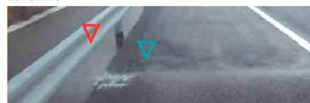
▽SAR (PS点) 防護柵 ▼水準測量：路面
