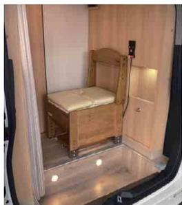
車両後部にトイレ機能を搭載。車内から、直接トイレへアクセスが可能
