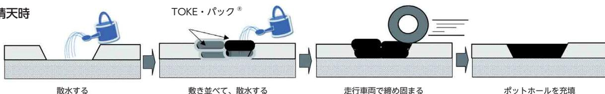
雨天時（雨水でフィルムが溶けるため、散水不要）
