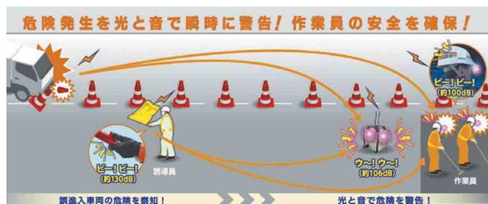
P70の可搬型緊急遠隔通報システムと連動させた、「緊急遠隔しらすんだー」もご用意しております。
