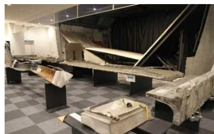
現物の天井板等を用いた実物大模型
