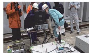
あと施工アンカーの健全度(アンカーボルトの断面欠損やアンカー定着箇所のコンクリートの損傷)の評価のための打音の周波数解析を用いた非破壊検査手法の開発
