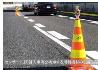
センサーにより侵入車両を検知する規制機材の実証実験
