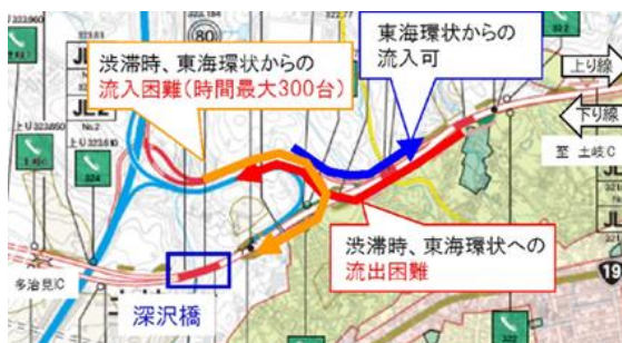
(深沢橋の立地条件に伴う車線運用の制約)
