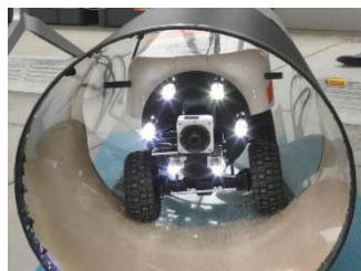
(小径管の内部を点検するロボット)
