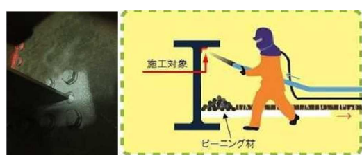
(金属粒の衝突により鋼材表面を硬化)
