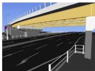
(鋼鉄桁橋の 3 次元モデル)
