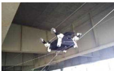
(ワイヤー吊下げ式ロボットによる撮影) (取得した画像を3次元モデル化) (ひび割れ幅ごとに自動に色分け)
