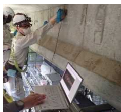
(広帯域超音波法の計測状況)
