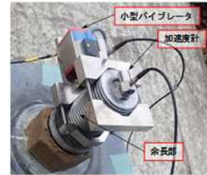
(開発したグラウンドアンカー健全度の計測器)
