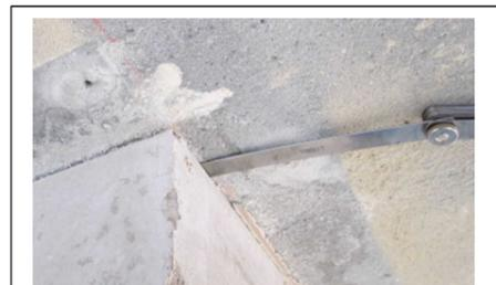
端部の拘束鉄筋なしの写真
