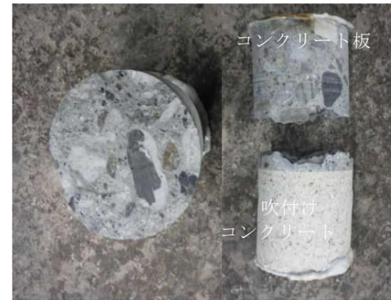
破断位置 A (コンクリート板)
