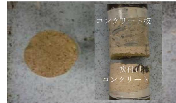
破断位置 B (吹付けコンクリート)
