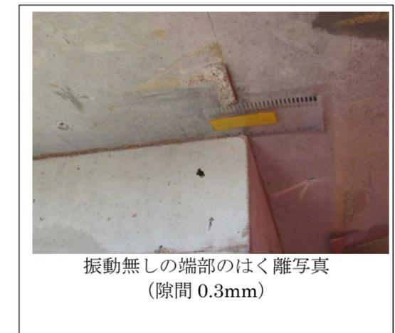
振動有りの場合、振動無しの場合と比較して鉛直センサーのひずみは大きく、目視確認ではく離の値 (隙間) は大きい。
