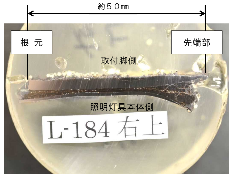
図 4-1-1 落下灯具右上脚切断研磨後
