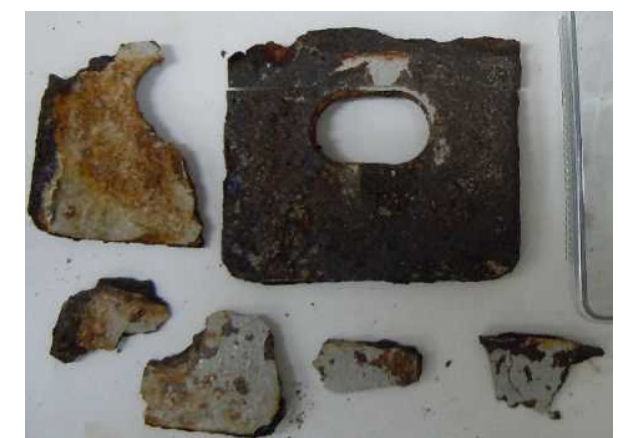
図 6-1-9 取付金具から取り外した取付脚 取付金具との接触面を表す (左下)
