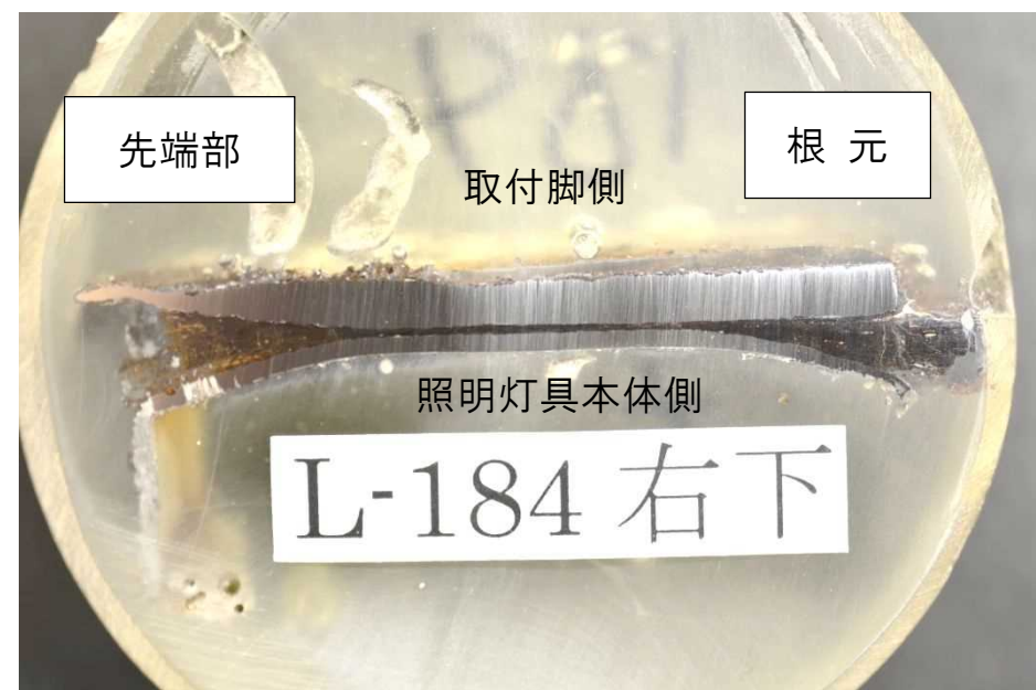
図 4-1-2 落下灯具右下脚切断研磨後
