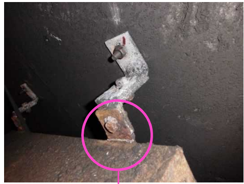
図7-1 取付脚の減肉推定線図
