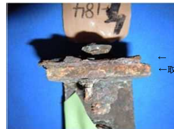
図 6-1-8 取付金具側の取付脚破断面（左下）
