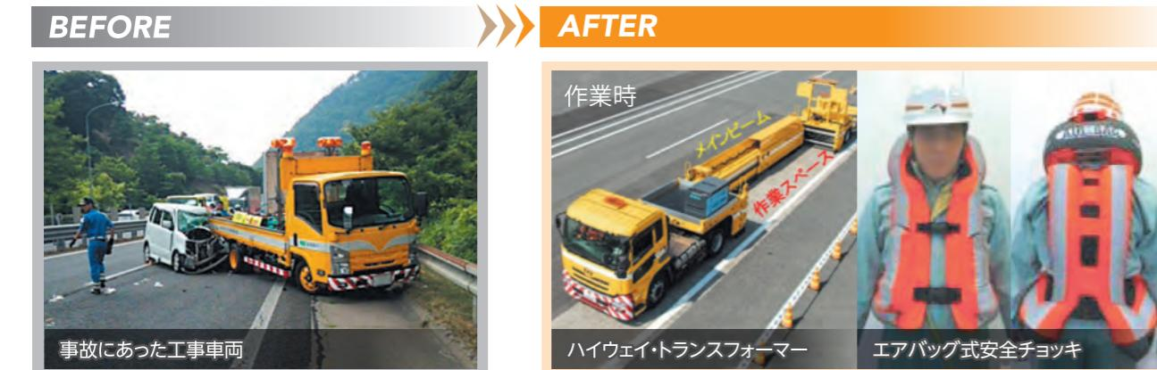
23 ハイウェイ・トランسفォーマー --- 高速道路での交通規制を伴う路上作業時の作業員の安全確保を目的とした「大型移動式防護車両」を「ハイウェイ・トランسفォーマー」と呼んでいます。
