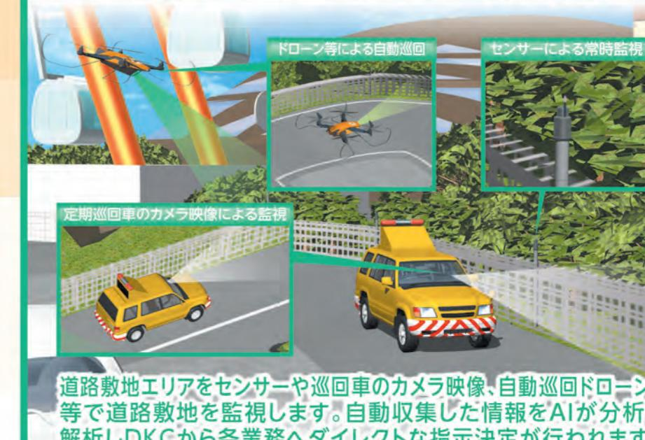
道路敷地エリアをセンサー・巡回車のカメラ映像、自動巡回ドローン等で道路敷地を監視します。自動収集した情報をAIが分析・解析しDKCから各業務へダイレクトな指示決定が行われます。
