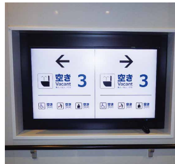
トイレブースの空き数を表示するデジタルサイネージ
