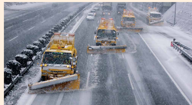
梯団走行による除雪作業
